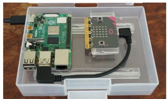
写真 9 : Raspberry piによるゲートウェイ
