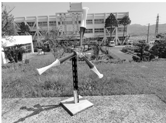
図1 スパイラルマグニウス風車(洲実開発品)
