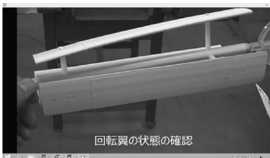
図3 新型マグリウス風車のテーパ回転翼
