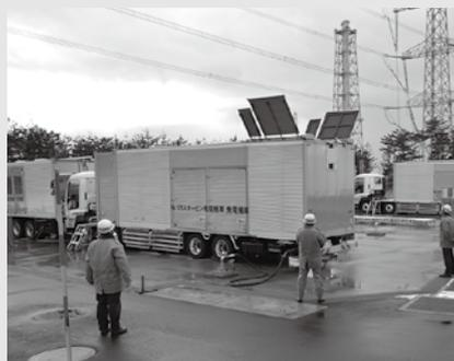
海拔約35mの高台に配備されている空冷式ガスタービン発電機 (GTG)による発電機の起動訓練を視察。バックアップの電源車も多数配備されており、緊急時の速やかな電源供給が可能となっている。
